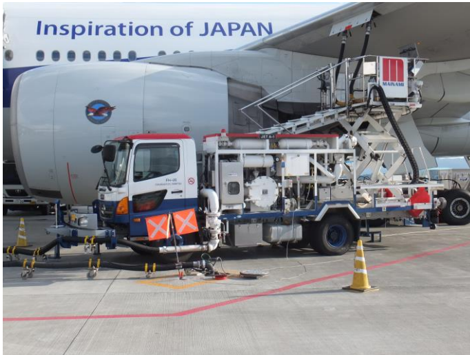
サービサーを使用した燃料給油
